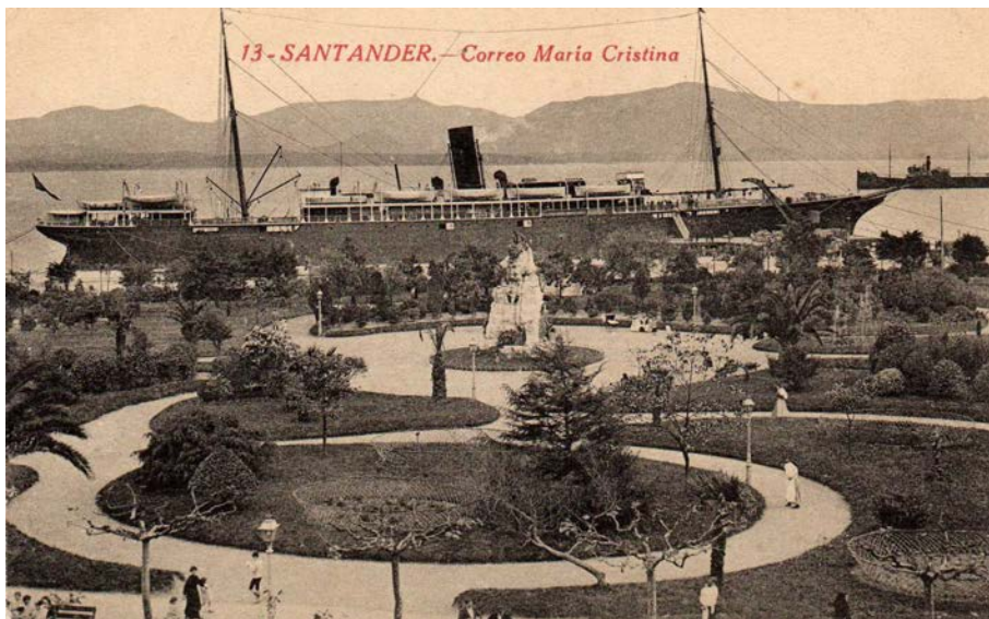
El vapor Reina María Cristina en Santander después de la modificación sufrida en 1908, en la que eliminaron dos de sus cuatro palos. - Postal de la época
